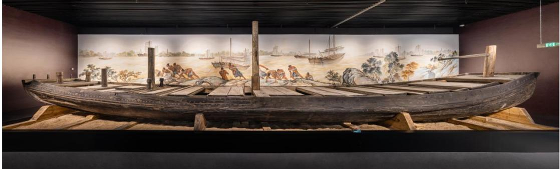
这艘古沉船于 2013 年在洛阳偃师首阳山镇洛河北岸被发现，经抢救性发掘，考古人员将其命名为洛阳运河一号，是迄今为止洛阳地区首次发现的古代沉船。出土时，船体长度约 20.14 米，首尾较窄，宽度为 1.2 米和 1.48 米，中部较宽，宽度为 3.48 米，残存最高处 1.42 米左右，船身最大高度 1.08 米。它由 13 个船舱组成，在船的首尾设置有生活仓，中部设置货仓，是一艘小型内河客货两用运输船。船体的木料种属较杂，有柏木、松木、榆木等，属于典型的民间就地取材。在船中和船首设置有双桅，动力是人力和风力共用，在遇到浅滩、风力不足和搁浅时，需纤夫合力将船拖行。根据碳 14 初步测定，这艘船应属明清时期。
